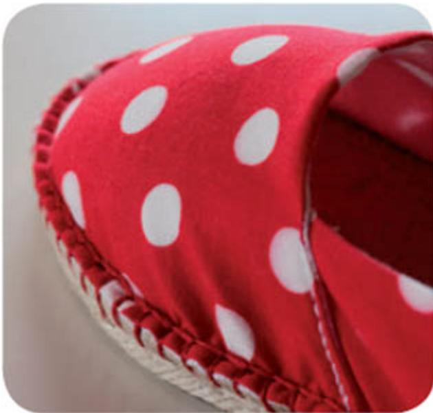
Bei einem Modell, das knappkantig auf die Außenkontur der Sohle genäht wird, ist die kleinere Sohlengröße besser geeignet.
