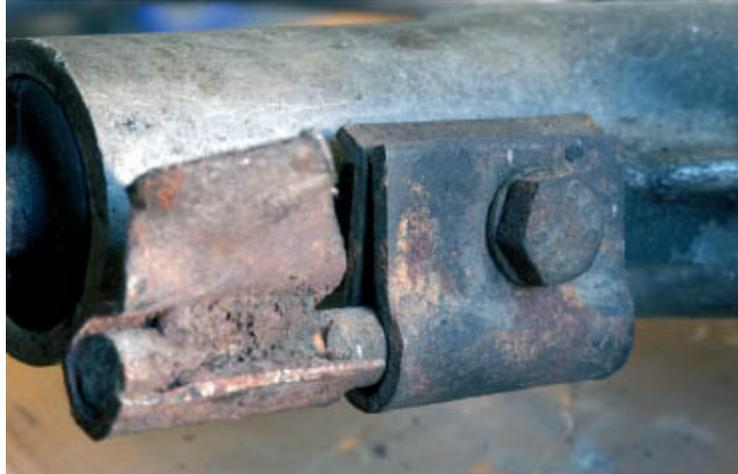
**Der Auspuff ist außerdem mit einer Schraube an der Schwingentraverse befestigt.**
