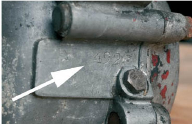
**Die Motornummer findet sich auf der Motorrückseite auf einem überstehenden flachen Anguss neben der Öleinfüllbohrung.**
