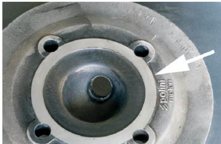
**Die Dichtfläche, mit der der Kopf auf dem Zylinder aufliegt, sollte gleichmäßig matt glänzen. Dunkle Stellen weisen auf Unebenheiten hin.**
