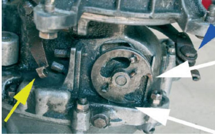
**Aushängen der Seilzüge: Ein Schraubnippel für den Kupplungszug (gelber Pfeil), zwei für die Schaltzüge (weiße Pfeile) und eine Mutter für den Bremszug der Hinterradbremse.**
