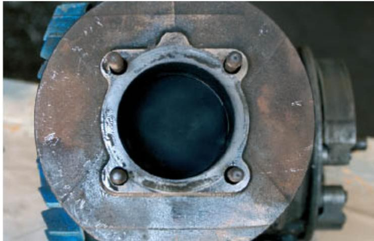
**Ein 125er-Motor mit langen Stehbolzen. Die Zylinder der kleineren Motoren sind auf kurzen Stehbolzen am Kurbelgehäuse angeschraubt.**
