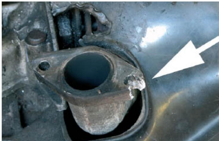
**Nach dem Entfernen wird die Ursache für die Pfschreparatur offensichtlich; Schäden wie dieser sind üblich.**
