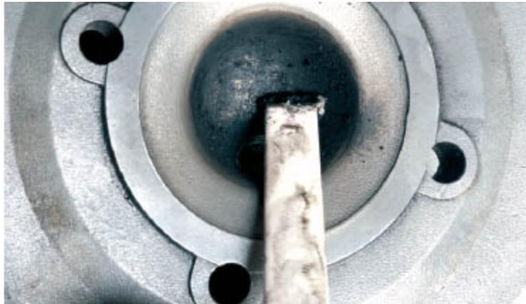
**Um Beschädigungen am Aluminiumguss zu vermeiden, darf die Ölkohle nur mit einem Holz- oder Kunststoffschaber entfernt werden. Eine Bohrmaschine mit einem Messingbürstenaufsatz erreicht auch für den Schaber unzugängliche Stellen.**
