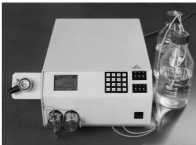
Da es Hochdruckflüssigkeitschromatografie heißt, müssen die Pumpen einiges leisten. Böse Zungen übersetzen HPLC mit „High Price Liquid Chromatography“, aber das ist natürlich Unsinn.
