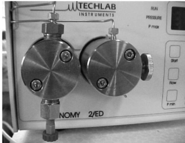
Sie sieht für den Laien auf den ersten Blick genauso aus wie die Zweikolbenpumpe. Auf den zweiten Blick ist allerdings zu erkennen, dass der Ansaugschlauch nur in einen Kopf hineinführt, nicht in beide. Dafür gibt es eine Kapillare vom Auslassventil des ersten Kopfes in den zweiten Kopf, also eine Hochdruckleitung.
