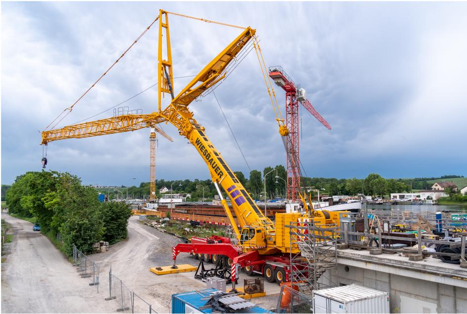
**Bild 1.2** Ein LTM 1750 mit angebautem Gitterausleger (in diesem Fall einer sogenannten Wippe) zur Verlängerung der Reichweite des Krans. Natürlich ist die maximal mögliche Last bei Verwendung von solchen Verlängerungen erheblich geringer als ohne.
