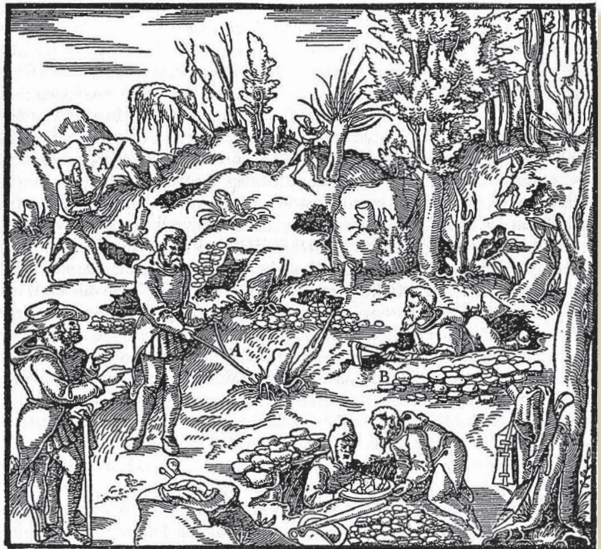
Aufsuchen von Erzlagern mittels einer Wünschelrute und durch das Graben von Schürfgräben.
