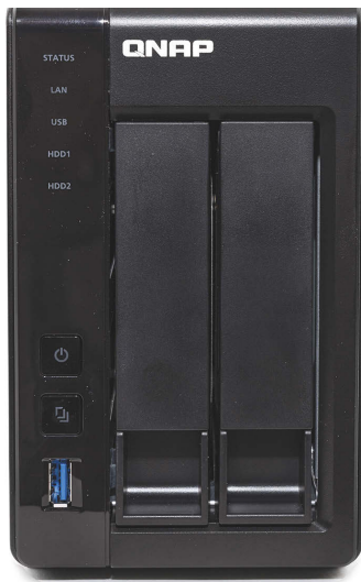
Abb. 1.1: Ein QNAP NAS mit zwei Festplatteneinschüben
