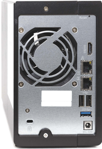
Abb. 1.2: Dieses Modell weist eine HDMI-Schnittstelle, zwei RJ45-Anschlüsse, 2 USB- und einen USB-3.0-Anschluss auf.
