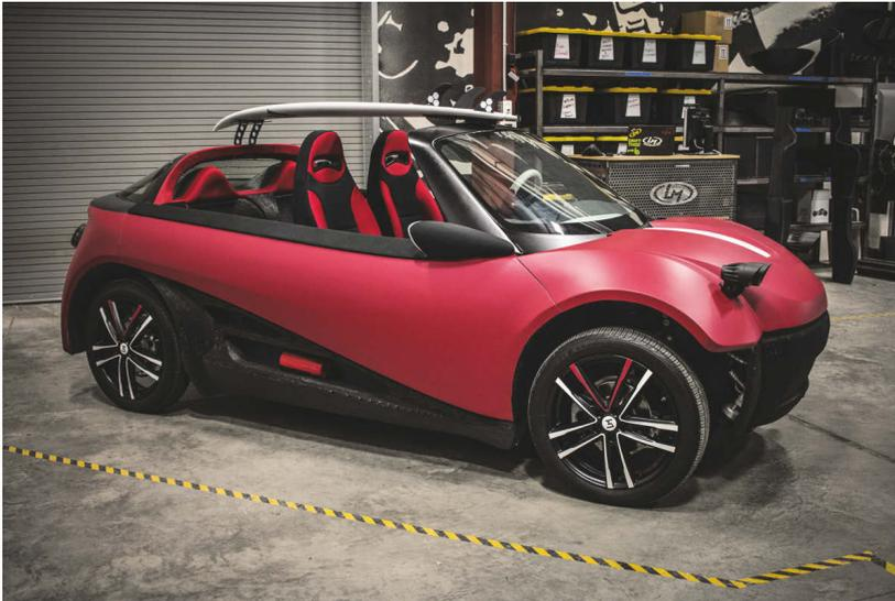
Abb. 1.1: Kfz aus dem 3D-Drucker von Local Motors
