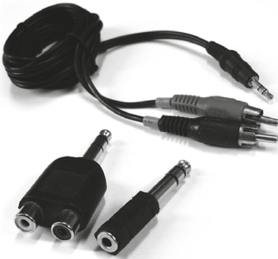
**Abb. 1.4:** Wenn es bei einer TRS-Klinken- oder TRS-Miniklinkenverbindung einen asymmetrischen Stereo-Output gibt, kann man mit preiswerten Adaptern helfen, zwischen diesen beiden Steckergrößen zu konvertieren (unten rechts) oder die Signale vom rechten und linken Kanal auf separaten Monoanschlüssen wie RCA-Cinchsteckern bereitstellen (oben und unten links).
