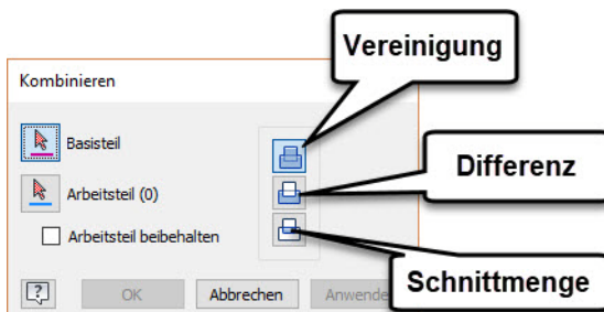
Abb. 1.22: Boolesche Operationen VEREINIGUNG, DIFFERENZ und SCHNITTMENGE
