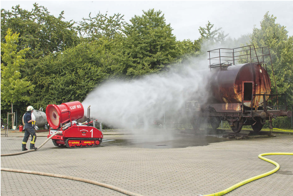
Ein Feuerwehrmann steuert einen Löschroboter zur Brandbekämpfung.
