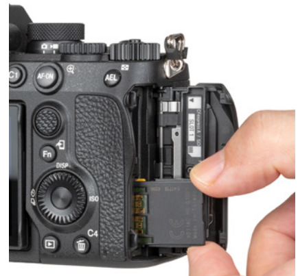
▲ Zwei Speicherkarten können in der a7IV eingesetzt werden.
