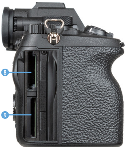
▲ Speicherkartensteckplätze, Steckplatz 1 oben und Steckplatz 2 unten.
