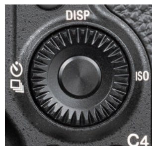
▲ Einstellrad, Mitteltaste und die vier mit Funktionen belegten Cursortasten auf dem Einstellrad, wobei die untere Taste zunächst noch mit keiner Funktion verknüpft ist.
