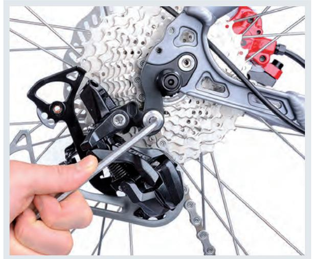
**3.** Jetzt lösen Sie mit einem Inbusschlüssel die Schaltwerkbefestigungsschraube und nehmen das Schaltwerk heraus. Lösen Sie beim neuen Schaltwerkfühler die untere Spannrolle heraus. Öffnen Sie den Schaltwerkfühler durch Verschieben.
