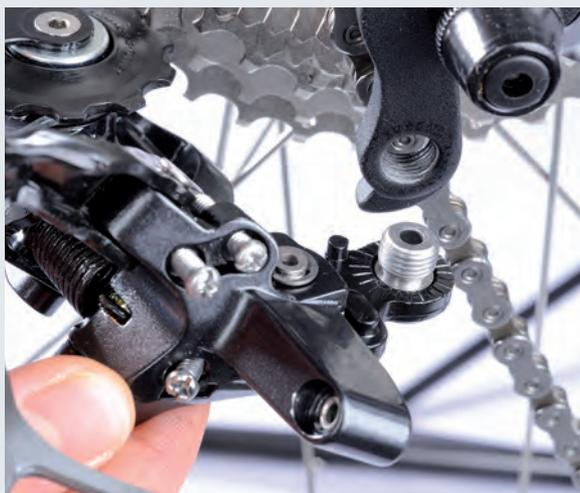
**4.** Setzen Sie das neue Schaltwerk an das Schaltauge. Achten Sie hierbei darauf, dass es in der richtigen Position angesetzt wird.
