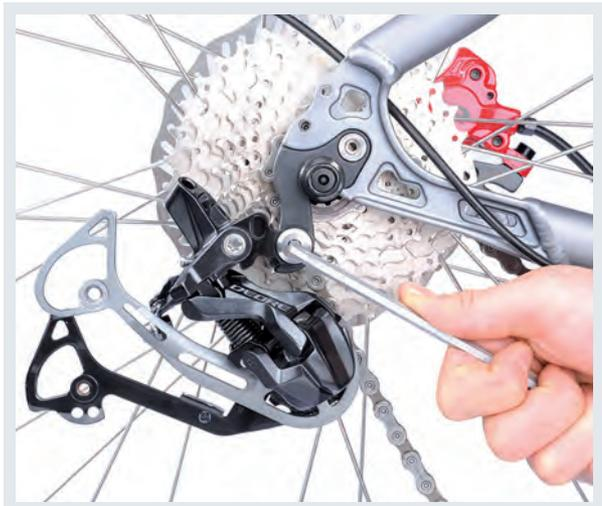
**5.** Schrauben Sie das Schaltwerk am Schaltauge mit dem Inbusschlüssel fest.
