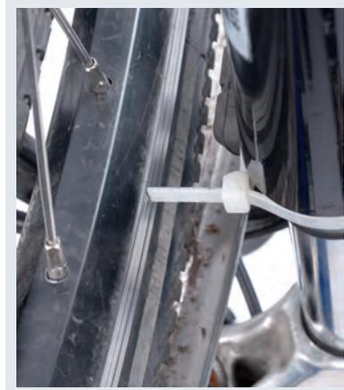
**6.** Die Feinarbeit, also wie fest man die Speiche zieht, erledigt man entweder in einem Zentrierständer oder nach dem Einbau des Rades, indem man mit Tesafilm oder Kabelbinder, die am Rahmen befestigt werden, die Zentrierung des Rades korrigiert.
