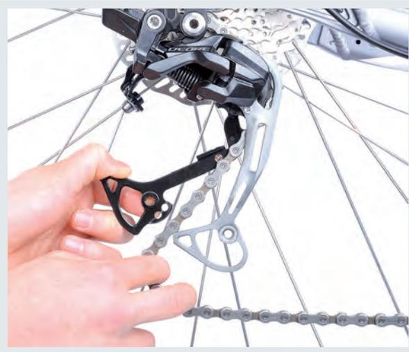
**2.** Beim Herausnehmen des Röllchens den Schaltwerkfühler mit einer Hand nach vorne drücken, damit die Kette entspannt ist. Die zwei Hälften des Schaltwerkfühlers lassen sich gegeneinander verschieben, um die Kette herauszunehmen.
