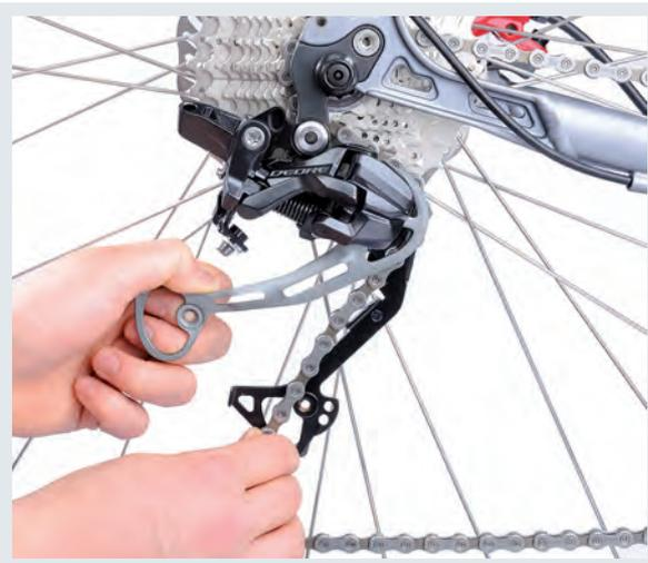
**6.** Fädeln Sie die Kette zwischen die zwei Arme des Schaltwerkfühlers ein.
