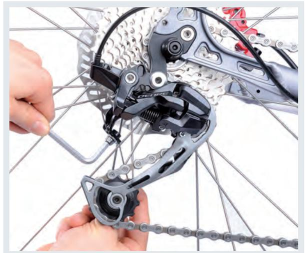
**7.** Setzen Sie die untere Spannrolle wieder ein, und ziehen Sie sie fest. Zum Schluss klemmen Sie den Schaltzug an der Klemmschraube wieder an.
