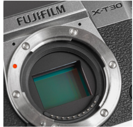
▲ Der X-Trans CMOS 4 Sensor der X-T30 (23,5 × 15,6 mm, APS-C, 26,1 Megapixel).
