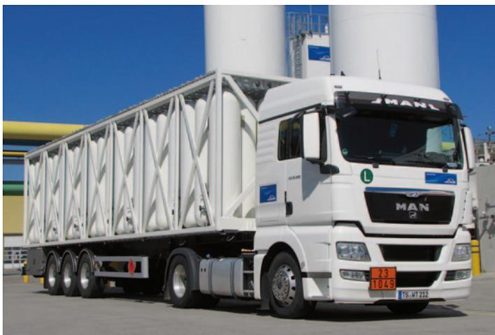
**Abb. 1.2** Modernes Großflaschenbatterie-Fahrzeug für die Belieferung von Wasserstofftankstellen (mit freundlicher Genehmigung der Fa. Linde Gas)
