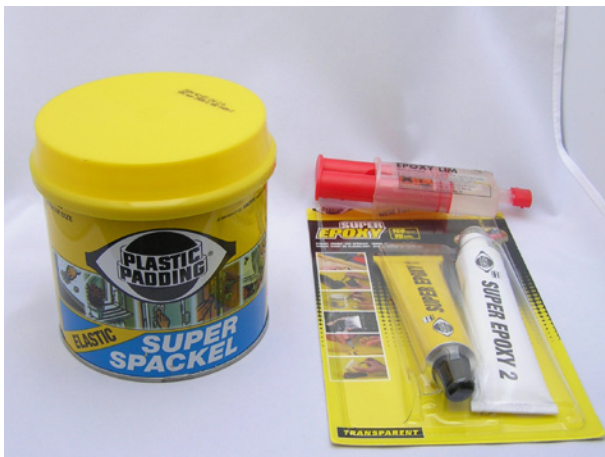
Bild 1.5 So genannte Zwei-Komponenten-Klebstoffe kommen häufig im Haushalt zum Einsatz. Dabei werden die beiden Komponenten miteinander gemischt, um eine chemische Vernetzungsreaktion auszulösen, bei der das Material aushärtet. Eine der Komponenten wird daher als „Härter“ bezeichnet. In diesem Fall erfolgt die Reaktion bei Atmosphärendruck und wird als Niederdruckreaktion bezeichnet.
