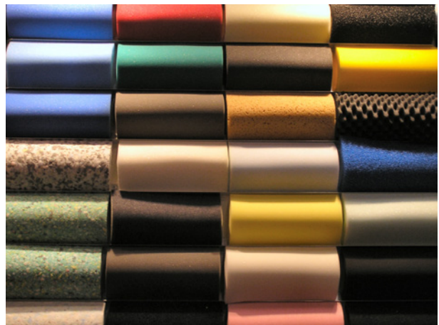
Bild 1.6 Polyurethane können als Duroplast oder als Thermoplast auftreten. Sie können auch hart oder weich sein, wie in den hier dargestellten Schaumblöcken.
