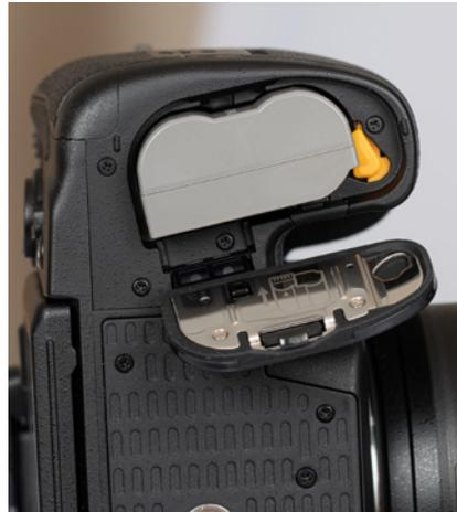
Wollen Sie noch einen älteren Akku benutzen und diesen prüfen, können Sie das über die Funktion **SYSTEM/Akkudiagnose**. Dort wird der genaue **Ladestatus** und die erwartete **Lebensdauer** auf einer Skala von 0-4 angezeigt.
