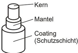
Bild 1.4: Aufbau der LWL-Faser
