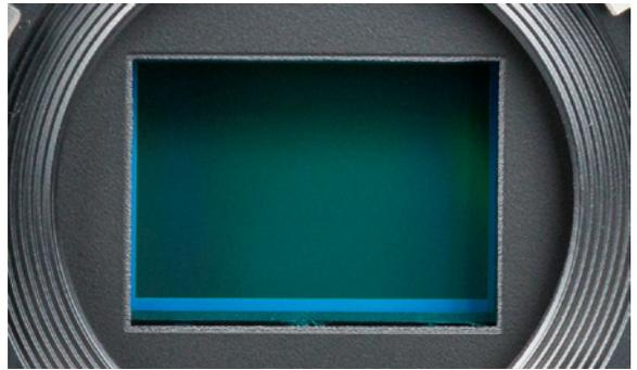
▲ CMOS-Sensor der EOS M100 mit integriertem Dual Pixel CMOS AF, über den auf 80 % der Sensorfläche scharf gestellt werden kann. Über die äußeren Bildränder kann somit nicht fokussiert werden.
