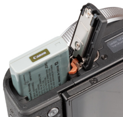
▲ In der PowerShot G7 X Mark III werden Akkus vom Typ NB-13L verwendet (3,6 V Nennspannung, 1250 mAh Kapazität).
