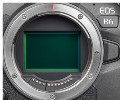
▲ Den CMOS-Sensor mit integriertem Dual Pixel CMOS AF II hat die EOS R6 von der Profi-Spiegelreflexkamera EOS 1DX Mark III geerbt.
