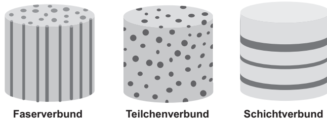
Abb. 1.8 Schematische Darstellung des Aufbaus von Verbundwerkstoffen
