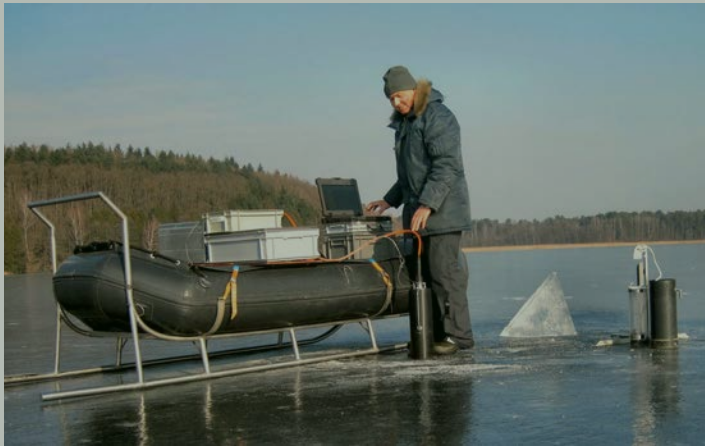
Abb. 10. Winter-Limnologie: Sondenmessungen und Probenahme finden bei geeigneten Eisbedingungen mit einer Schlauchboot-Schlitten-Konstruktion statt, die nach dem Entwurf von Geländetechniker Ingo Henschke (Foto), mit EFRE-Mitteln finanziert, in der universitätseigenen Werkstatt gebaut wurde. Das Foto entstand im Februar 2017.
