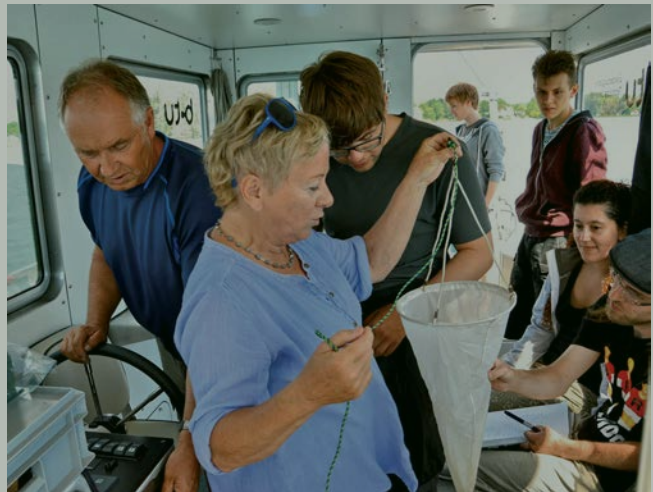
Abb. 6. Lehrstuhlleiterin Prof. Brigitte Nixdorf demonstriert Studierenden während eines Praktikums an Bord eines Praktikums an Bord des KLIMAKAT den Gebrauch des Planktonnetzes.
