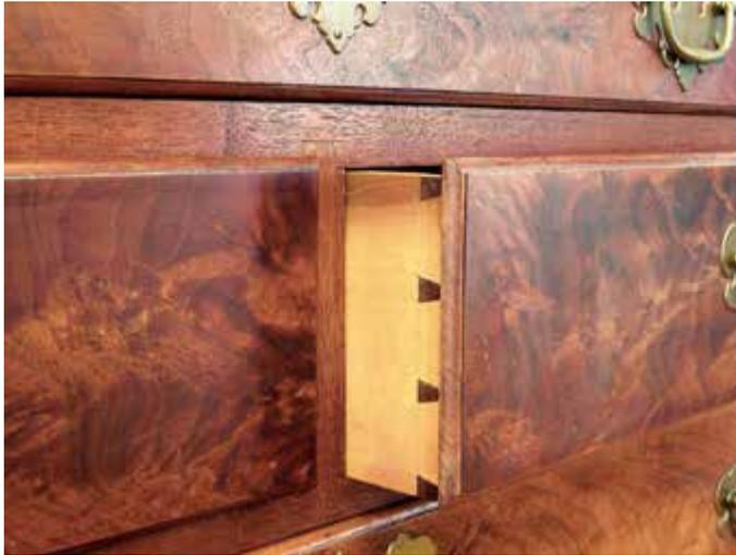
**Die Aufdopplung verdeckt die Fuge.** Aufgedoppelte Vorderstücke passen gut zu traditionellen Möbelstücken, sie setzen optische Akzente und verdecken zugleich etwaige Fugen zwischen der Schublade und dem Korpus.
