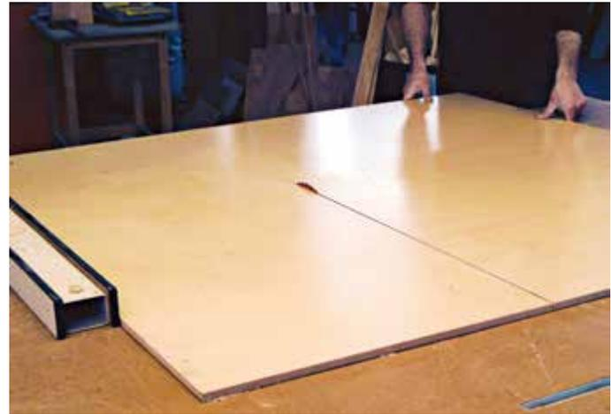
**Schon vor dem Bau oberflächenbehandelt.** Wenn man Multiplex mit einem oberflächenbehandelten Deckfurnier verwendet, kann man die Bauteile der Schublade auf Maß schneiden, die Verbindungen anschneiden und die Schublade zusammenbauen, ohne später ein Oberflächenmittel auftragen zu müssen.
