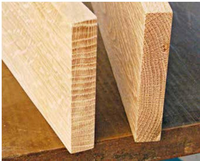
**Hirnholz kontrollieren.** Die Wachstumsringe des riftgeschnittenen Weiß-eichenbretts auf der linken Seite stehen senkrecht zu seiner Seitenfläche („stehende Ringe“), während sie am rundgeschnittenen Brett rechts eine Reihe von Bögen bilden, die fast parallel zur Seitenfläche verlaufen.
