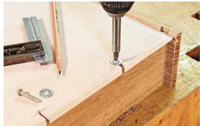
oben: **Faserverlauf im Schubladenboden.** Bei Vollholzböden muss die Holzfaser von Seitenstück zu Seitenstück verlaufen. In die hintere Kante des Bodens schneidet man an der Tischkreissäge Schlitze ein, durch die der Boden mit Schrauben am Hinterstück fixiert wird. So kann das Holz des Bodens arbeiten.
