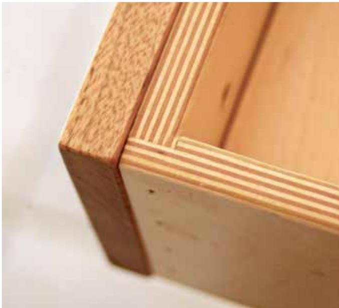
**Multiplex sieht gut aus.** Das sogenannte Multiplex-Sperrholz, zum Beispiel aus Birkenholz, ist biegesteif und belastbar. Da es im Inneren keine Fehlstellen hat, eignet es sich auch gut für Schubladenbauteile, deren Kanten sichtbar sind.
