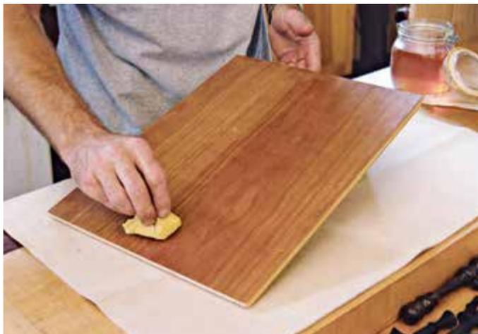
**Leicht aufzutragen.** Ein Oberflächenmittel mit dem Ballen aufzutragen ist viel leichter, wenn der Boden nicht in der Schublade steckt, weil man problemlos bis in die Ecken gelangt. Und auch der Boden selbst kann separat behandelt werden, was für eine glattere Oberfläche sorgt.
