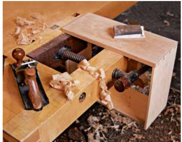
**Kein Boden, der stört.** Wenn man den Boden aus der Schublade nimmt, kann man sie leicht an der Hobelbank festspannen, um zu schleifen und Einpassarbeiten auszuführen.
