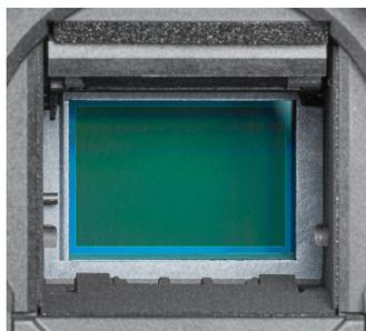
▲ Bei hochgeklapptem Spiegel ist der Sensor der EOS 200D zu sehen (22,3 × 14,9 mm, APS-C-Format, Cropfaktor 1,6).
