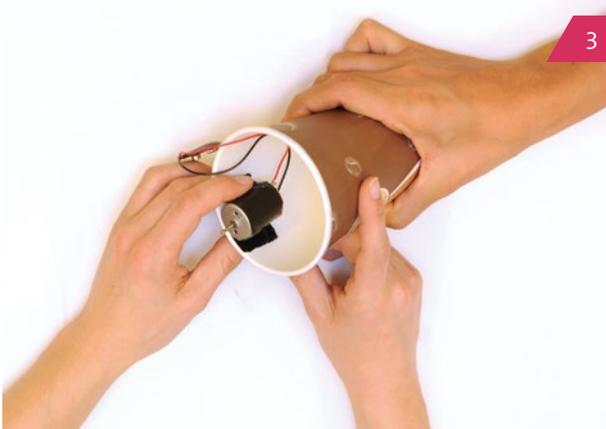
Der Motor muss so in das Innere des Bechers geklebt werden, dass die bewegliche Spitze vollständig herausragt. Das ist wichtig für die spätere Unwucht (der Korken), die daran befestigt wird und frei drehen muss.
