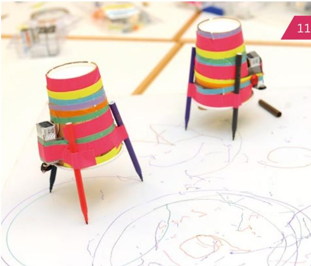
Wenn alle Stiftkappen abgezogen sind und die Kabel des Batterieclips beide Batteriepole berühren, ist der Stromkreis geschlossen. 9 Volt Strom fließen in den Motor und bringen diesen in Bewegung. Die Roboterbeine bewegen sich mit und lassen bunte Bilder entstehen.
