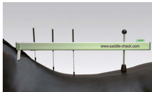
Messwerkzeug für das Bundeseinheitliche Mess-System für den Pferderücken des BVFR (Bundesverband der Fahrzeug- und Reitsportsattler)
