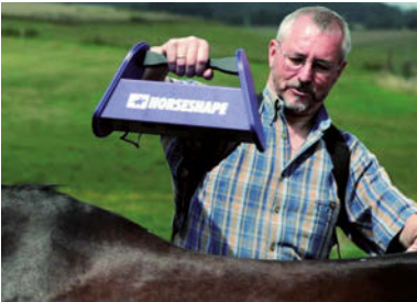
Ein Laser zur Rückenvermessung der Firma Horse Shape
