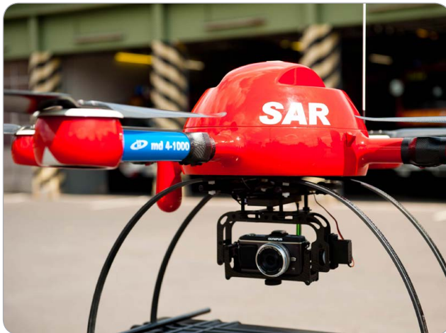
Drohne zum SAR-Einsatz (Search and Rescue) - Microdrones MD4-1000.
