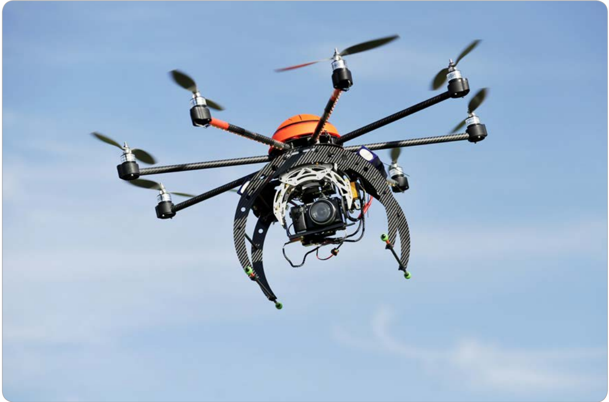
Kameradrohne CopterCam8 mit einer selbststabilisierenden Kamerahalterung (Gimbal).
