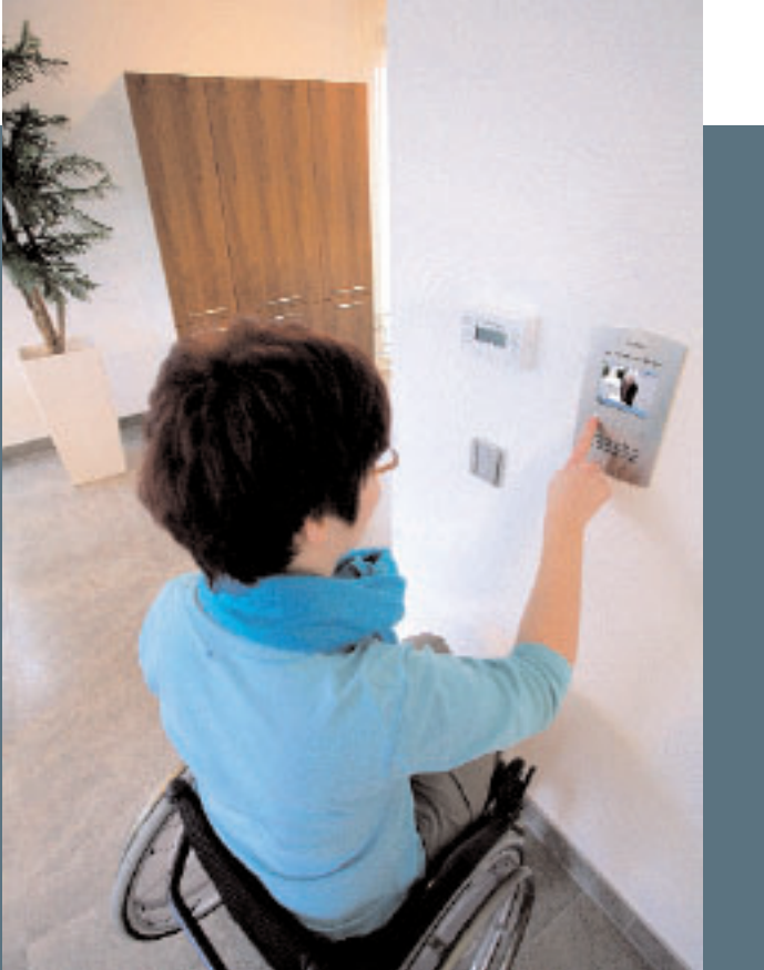
Viele Hilfseinrichtungen sind auch für unbeeinträchtigte Bewohner von Nutzen: Hier eine Türsprechanlage mit Kamera (Foto: SchwörerHaus, s. S. 12).
