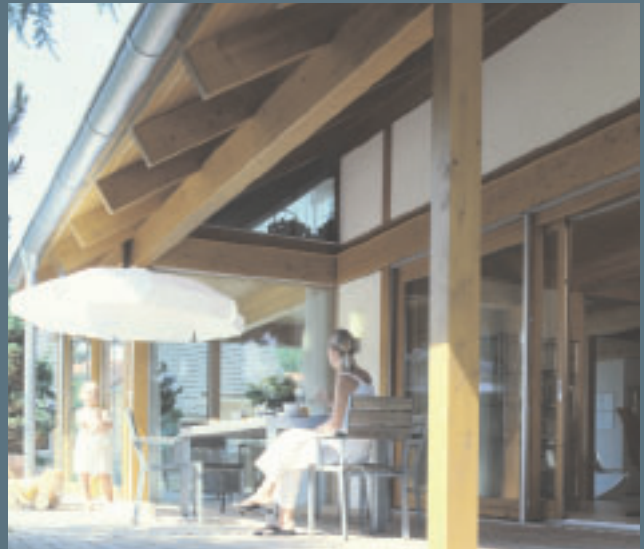
Niveaugleiche Haus- und Terrasseneingänge lassen sich ideal durch ein auskragendes Dach schützen. Nebenbei können so qualitätvolle überdachte Freibereiche entstehen (Seeger-Ullmann Architekten, s. S. 38; Foto: Rathscheck Schiefer)
