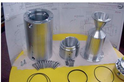
Kühlmantel: Die SLR10k-I Triebwerke für Project Enterprise werden durch Bioethanol gekühlt, was eine lange Lebensdauer und konstantere Leistung garantiert.
