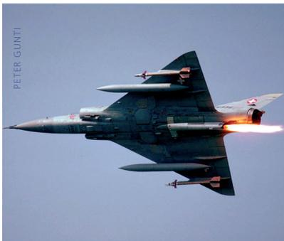
Mirage IIS und Raketenantrieb SEPR 841: Doppelte Power in großen Höhen.
