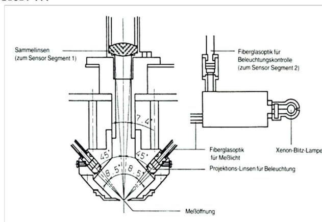
... Messgeometrie  $45/0^\circ$  des Spektralphotometers CM-503c. Hierbei wird Licht im  $45^\circ$ -Winkel von der Apparaturachse emittiert und das vom Objekt veränderte und reflektierte Licht unter  $0^\circ$  von den Sensoren des Spektralphotometers detektiert (Bildquelle: Bedienungsanleitung von Minolta).
