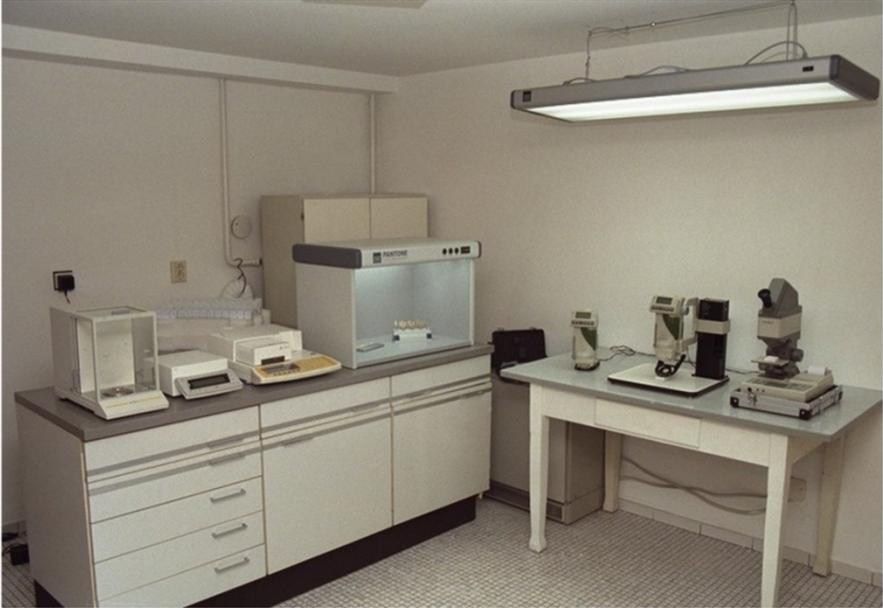
Versuchsanordnung von links nach rechts: Mikrowaage MC21S, Sartorius Moisture Analyzer MA100, Lichtkabine, Farbprüfleuchte (oben), Spektralphotometer CM503i, Spektralphotometer CM503c und mikroskopisches Chromameter CR-241.
