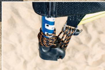
**Mastverlängerung:** Adapter, der die Längendifferenz zwischen Mast und Segel ausgleicht; Am Vorliekspanner wird das Segel in Längsrichtung gespannt.
