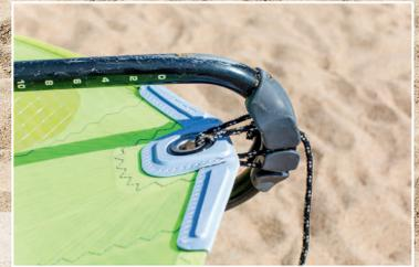
**Trimmschot:** Tampen, mit dem das Segel am Gabelbaum-Endstück in Querrichtung gespannt wird; die hintere Ecke des Segels heißt »Schothörn«.
