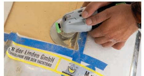
**3** Die Ecken und Kanten des Kerns lassen sich schlecht dünner schleifen, daher sollte dort die Oszillationssäge verwendet werden →
