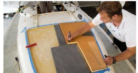
**3** Für die beschlagsfreien Flächen kommt 20 Millimeter starker Airex-Schaum zum Einsatz. Die Platten sollten möglichst passgenau zugeschnitten werden
