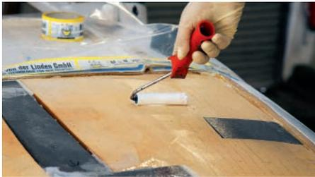
**4** Wenn alles passt, wird der Kern mit Harz benetzt. Dann werden die Spalten und Einschitte mit einer dünnen Mischung aus Harz ...
