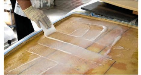
**9** Zum Kleben wird wieder eine mayonnaiseartige Mischung aus Epoxidharz und Baumwollflocken verwendet. Sie wird mit einem Zahnpachtel gleichmäßig aufgetragen
