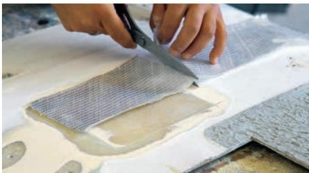
**7** ... der Dicke von 430-Gramm-Biaxialgelege und einer Lage 163-Gramm-Glasseide. Das Glas wird zu Lochgröße passend zugeschnitten, die Decklage etwas größer
