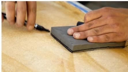
**2** Die Verstärkung für den Fallumlenker muss an die Rundung des Decks angepasst werden. Dazu wird die Kontur übertragen und der Schaum zurechtgeschliffen
