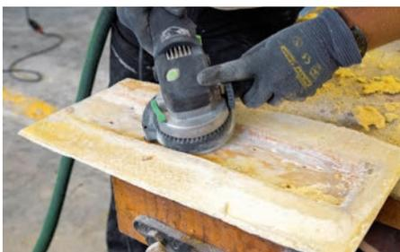
**1** Der Mastfuß soll eine stabile Unterfütterung erhalten. Dazu muss ein Keil eingeklebt werden. Als Erstes wird die Unterseite des Deckstücks von Spachtelresten gesäubert
