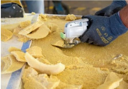
**1** Das alte Kernmaterial kann mit der Oszillationssäge oder per Stechbeitel herausgebrochen werden. Bei Balsaholz ist etwas mehr Arbeit nötig. Das nicht verrottete Material lässt sich mit einem Stechbeisen entfernen
