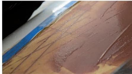
**5** ... und Microballoons ausgespachtelt, hier braun zu sehen. Anschließend wird eine Klebmischung aufgetragen
