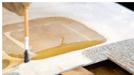
**8** Den Reparaturbereich mit Harz benetzen; die Glasfasern auflegen und gut durchtränken. Das Harz mit einem Spachtel einmassieren. Wenn das Glas klar geworden ist, folgt ...
