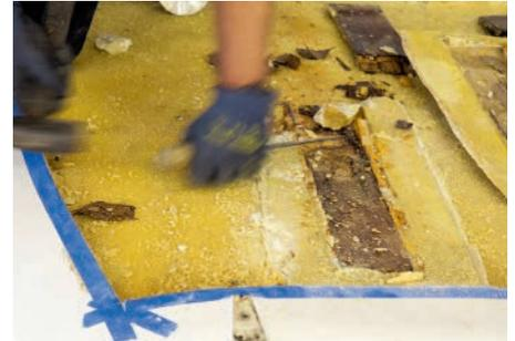
**3** Beim früheren Reparaturversuch wurde das Außenlaminat lediglich mit Polyester-spachtel aufgeklebt. Dieser haftet schlecht und lässt sich mit dem Stechbeitel ohne größere Probleme abschlagen
