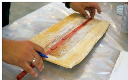
**2** Der nötige Kiel wird ausgemessen und aus Coosa-Schaum angefertigt. Das Material ist glasfaserverstärkt, sehr druckfest und lässt sich mit Holzbearbeitungswerkzeugen schneiden
