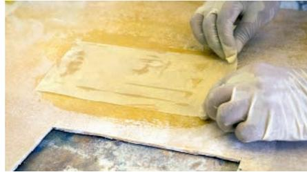
**5** Zur Stabilisierung wird noch eine Lage 163-Gramm-Glasfasergewebe aufgelegt. Nach dem Aushärten wird die Unterseite des Deckels mit 36er-Papier grob angeschliffen
