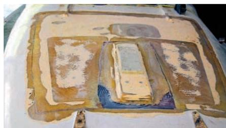
**2** Für zwei Lagen 430-Gramm-Biaxialgelege und eine Lage 163-Gramm-Glasseide muss das Deck etwas mehr als ein Millimeter ausgeschliffen werden
