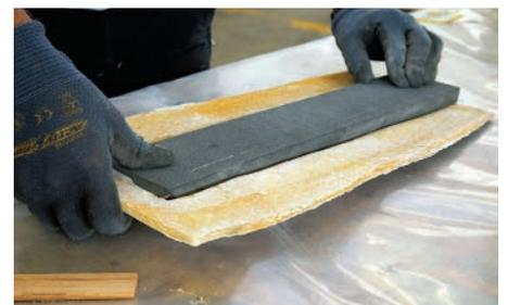
**3** Die Keilform wird nach dem Verkleben mit der Decksschale zurechtgeschliffen. Daher muss der Schaumrohling zunächst nur grob angepasst werden
