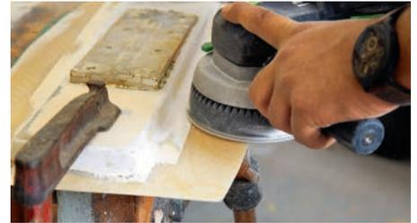
**6** Fertig ausgehärtet wird die Unterseite plan geschliffen und das Laminat der Decksschale zum Schäften angeschrägt. Die Schräge sollte etwa der zwölffachen Materialstärke entsprechen
