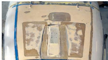
**2** Trockenprobe. Die Decksschale wird aufgelegt, um zu prüfen, wo die Dicke des Kerns noch korrigiert werden muss
