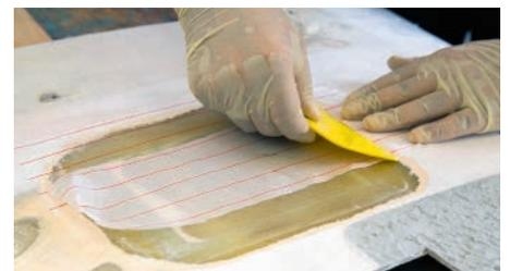
**9** ... Abreißgewebe. Es nimmt überschüssiges Harz auf und sorgt somit für eine gleichmäßige Oberfläche, auf der ohne Zwischenschliff weitergearbeitet werden kann
