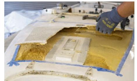
**6** Wenn dem so ist, kann er abgehoben werden. Er haftet nur noch an wenigen Stellen. Bei Balsaholz ist mehr Kräfteinsatz erforderlich
