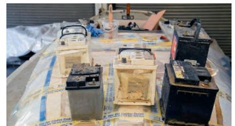
**9** ... beschwert. Der eingeklebte Kern hat die Beulsteifigkeit des Aufbaus erhöht, trotzdem sollte das Deck abgestützt werden
