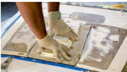
**7** Die Unterseiten von Decksschale und Mastfuß werden ebenfalls mit Harz benetzt und die Teile aufgesetzt und andrückt
