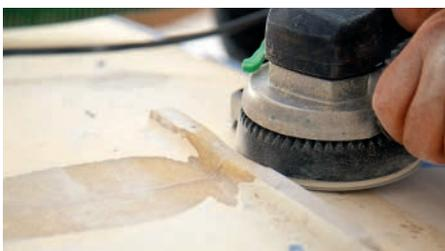
**1** Um das Außenlaminat wieder kraftschlüssig zu verbinden, wird die Trennstelle zunächst rundherum ausgeschliffen. Das Tal muss so tief sein, wie das neue Laminat aufträgt
