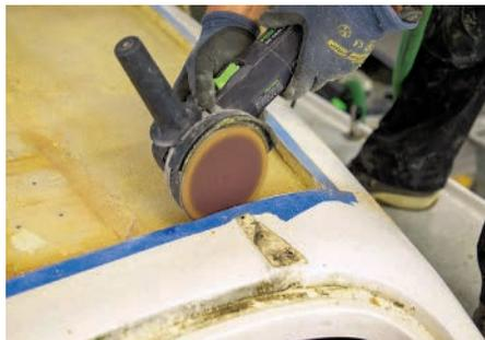
**5** Da eine Oszillationssäge verwendet wurde, sind die Schnittkanten recht sauber. Sie sollten aber noch einmal begradigt und geschliffen werden. Dann fällt später das Einpassen des neuen Kernmaterials leichter
