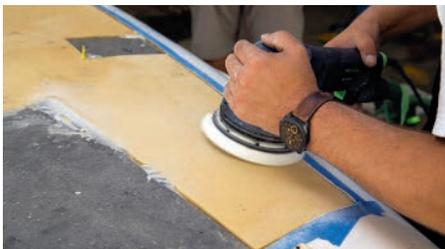
**1** Selbst wenn die Materialstärke mit der des Originals übereinstimmt, muss der Kern in der Regel noch geschliffen werden
