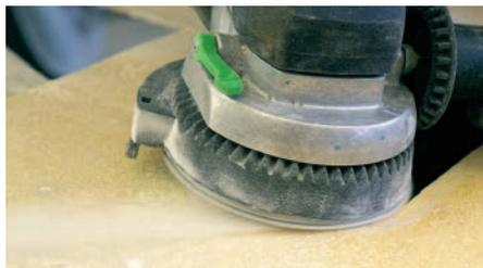
**2** Nachdem der Deckel von Schaumresten befreit und gesäubert wurde, werden die Kanten der Pilotöffnung und des Ausschnitts von unten schräg geschliffen
