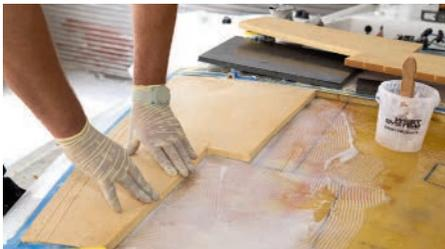
**10** Die Kernsegmente auflegen und in den Epoxidkleber drücken. Dabei von einer Kante zur anderen arbeiten. So kann überschüssiger Kleber entweichen
