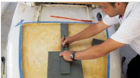
**1** Mastfuß und Beschlüge werden mit Coosa-Schaum unterfüttert. Das Material ist leichter als Sperrholz und wasserbeständig. Die Dicke entspricht der des Originalkerns
