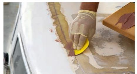
**3** Vermutlich treten durch das Schleifen Lufteinschlüsse zutage. Sie werden zusammen mit eventuell vorhandenen Fugen mit einer Microballoon-Mischung verspachtelt
