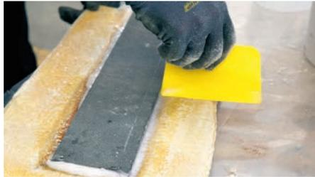
**5** Beim Einsetzen des Schaumstücks sollte der Kleber überall herausquellen. Das überschüssige Material danach sauber abziehen, sonst muss später mühsam geschliffen werden
