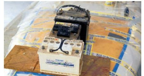
**12** ... muss unbedingt darauf geachtet werden, dass sich die in der Regel weiche Innenlage des Decks nicht durchbiegt. Im Zweifel sollte das Deck von unten abgestützt werden
