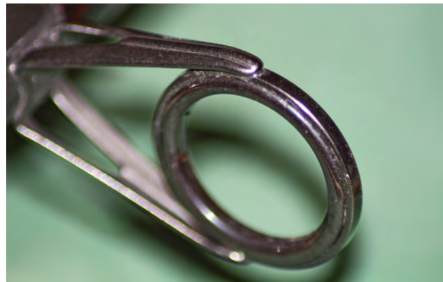
Die Ringe einer Rute müssen spiegelglatt sein und dürfen nicht die geringsten Kratzer oder Risse aufweisen.
