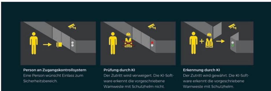
**Abb. 1.2** KI-gestützte Zugangskontrolle. (Quelle: Geutebrück)
