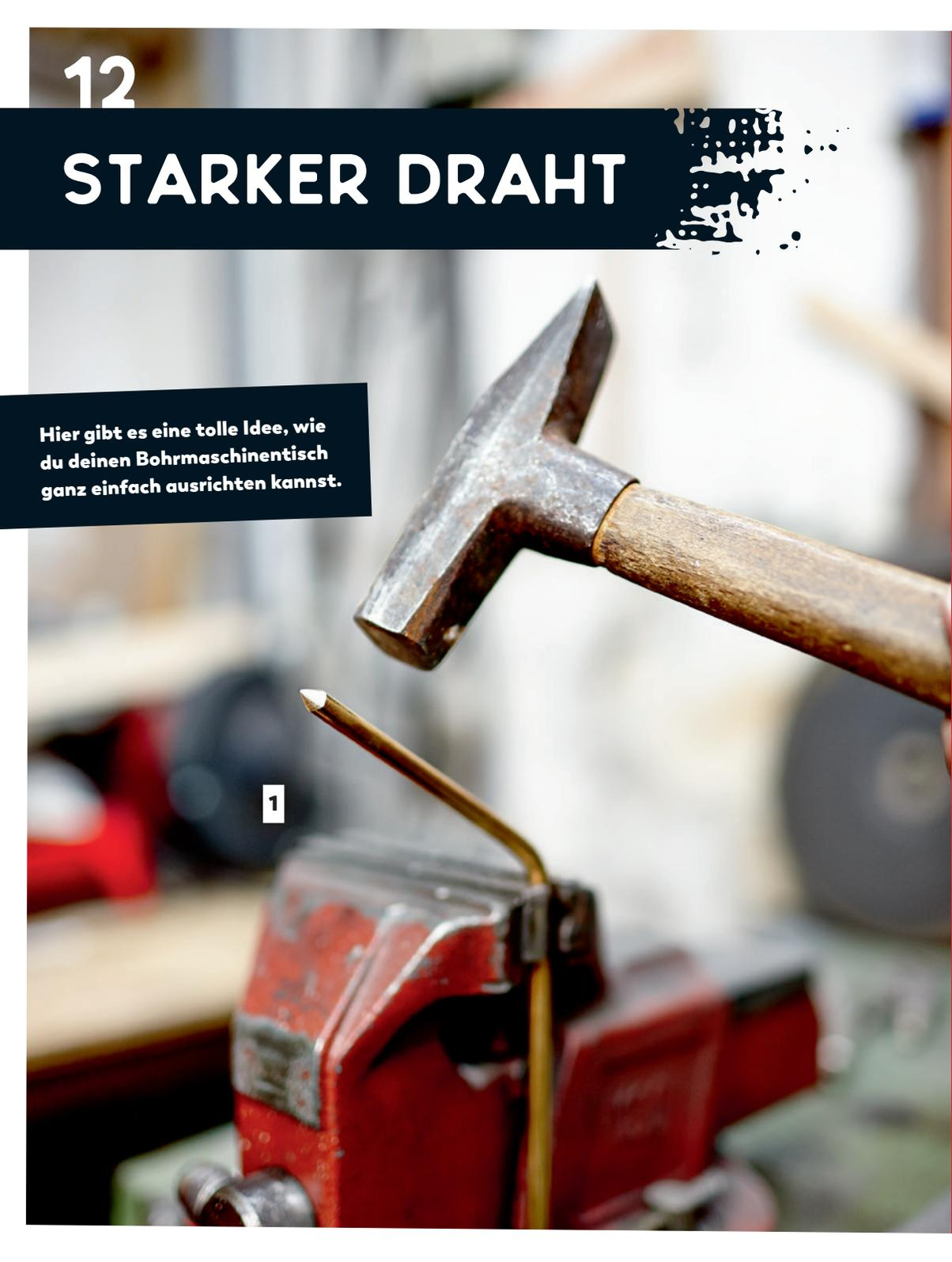
**1** Jeweils das Ende eines dünnen Rundstahls um 45 Grad biegen.
