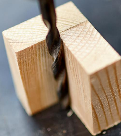
**Um gerade zu bohren, einfach zwei Holzblöcke rechtwinklig zusammenleimen und die Ecke als Führung benutzen. So lässt sich der Bohrer optimal führen.**
