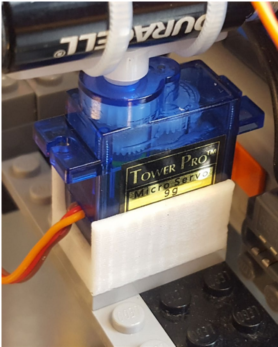
Mein Servo-Adapter aus dem 3D-Drucker
