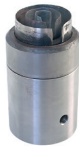
(A.39) Anschlagfutter mit drei Ringen
