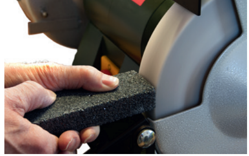
(A.05) Abrichten einer Schleifscheibe
