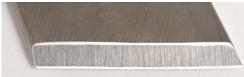
(A.25) vergrößerte Darstellung einer abgezogenen Werkzeugfase. Hier ist deutlich zu erkennen, dass beim Hohlanschleif nur die obere und die untere Kante geglättet wird.
