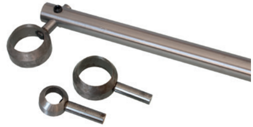
(A.54) Ringstahl mit auswechselbarem Schneidring von „Fall“. Der Schneidring kann auch stirnseitig in den Schaft gesteckt werden. Der Schneidring wirkt wie die Schneidkante eine Röhre und ist so auch gut für Querholzarbeiten einsetzbar. (C.I.Fall)
