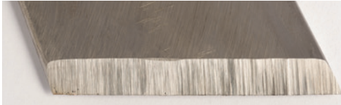
(A.24) vergrößerte Darstellung einer grob geschliffenen Werkzeugfase
