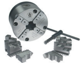
(B.02) Vierbackenfutter mit Standard-Innen- und -Außenbacken und Universalbacken zum Aufschrauben von Spannsegmenten (TOS/steinert)
