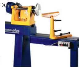
(A.47) Außendrehvorrichtung rechts, Spindelstock auf dem Bankbett nach rechts verschoben
