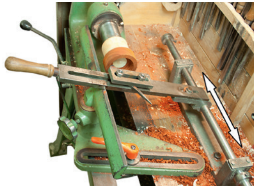
(B.21) Bankfräser an einer Drechselbank mit eingespannter Querholzröhre
