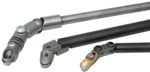
(A.51) spandickenbegrenzende Werkzeuge mit mehrfach verstellbaren Schneidträgern (Munro)
