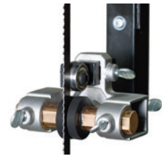
(B.16) Rollenführung an einer Bandsägemaschine
