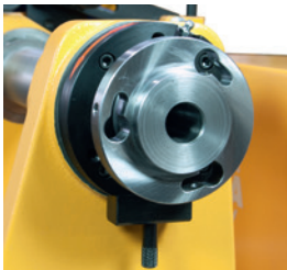
(B.23) Spindelkopf einer Drechselbank mit bajonettartiger Futterbefestigung
