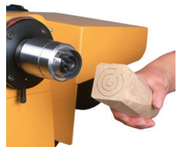
(A.40) Anschlagfutter im Einsatz
