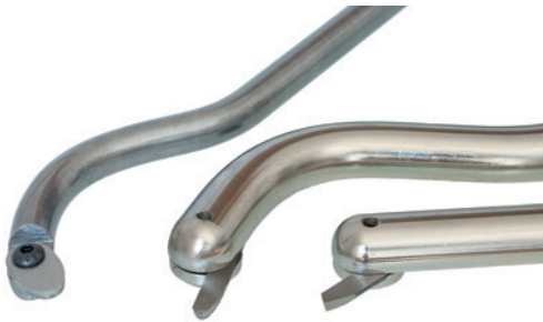
(A.52) Ausdrehstähle mit schabender Wirkung (Sorby)
