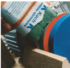
(A.31) Hartfilzscheiben und Schleifpaste für das Polieren von Werkzeugfasen
