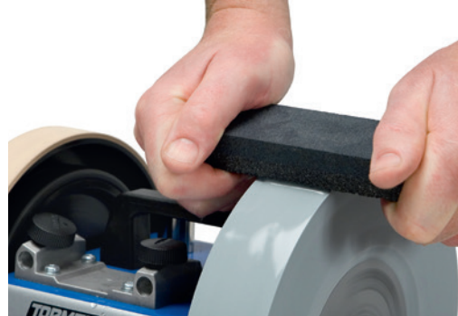
(A.11) „Schärfen“ bzw. aufrauen des Schleifsteines einer Nassschleifscheibe
