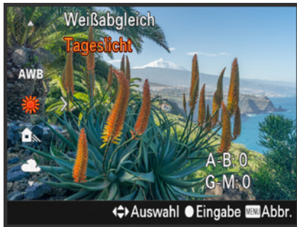
▲ Einstellen des Weißabgleichs durch Drücken der C1-Taste und anschließender Auswahl der Vorgabe mit den Cursortasten (Joystick-Verwendung auch möglich).
