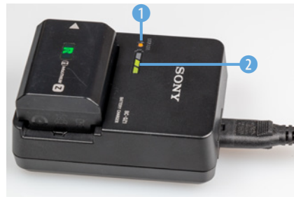
▲ Ladegerät mit Akku vom Typ NP-FZ100 (7,2V/16,4Wh, 2280 mAh).
