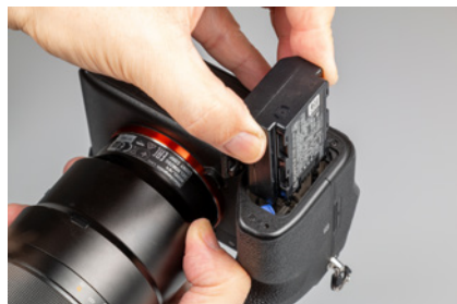
▲ Beim Einlegen in den Akkuschaft wird der blaue Verriegelungshebel mit der Seite des Akkus hineingedrückt.
