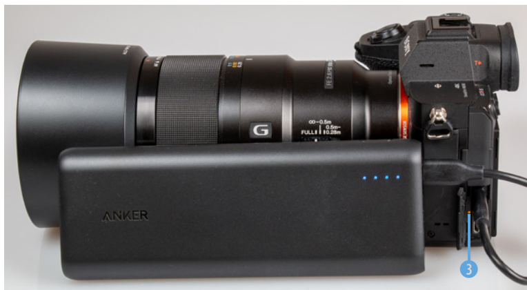
▲ Das Akkupack (hier ANKER PowerCore Speed 20000 PD) liefert Strom via USB an den in der α7R IV eingelegten Akku. Die Ladekontrollleuchte zeigt dies an.
