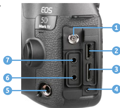
▼ Die Anschlussbuchsen der EOS 5D Mark IV
