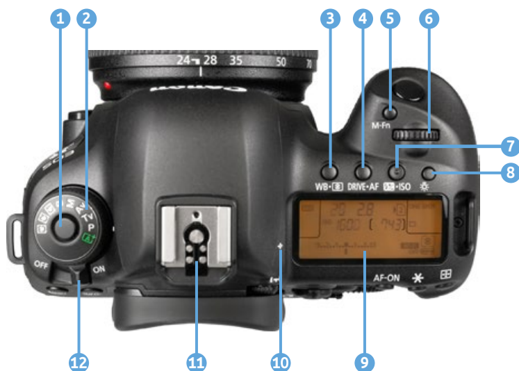
▲ Bedienelemente auf der Oberseite der EOS 5D Mark IV
