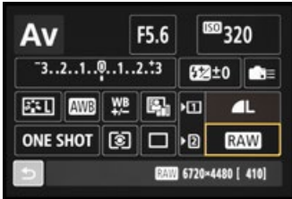
▲ Separate Aufzeichnung: CF-Karte für JPEG und SD-Karte für RAW
