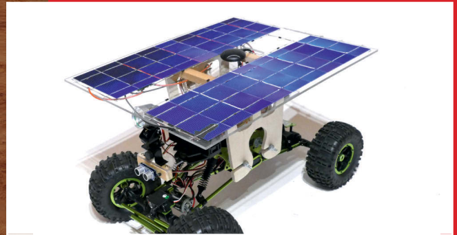
Solaranlage zum Laden des Akkus
