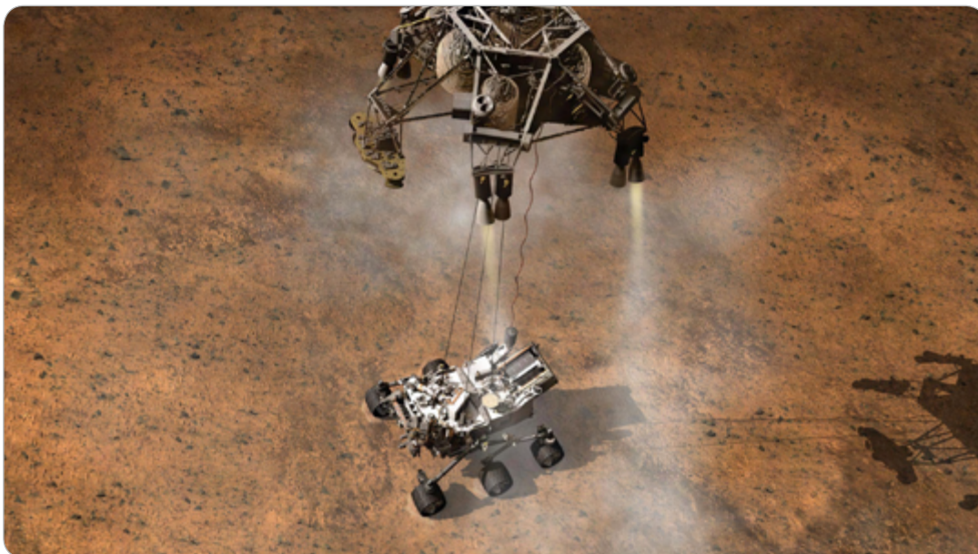
Künstlerische Darstellung des Marsrovers Curiosity beim Landemanöver mithilfe des Skycrane.
