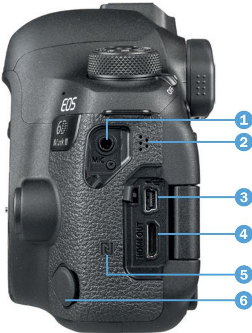
▲ Lautsprecher, Anschlussbuchsen und NFC-Antenne der EOS 6D Mark II.
