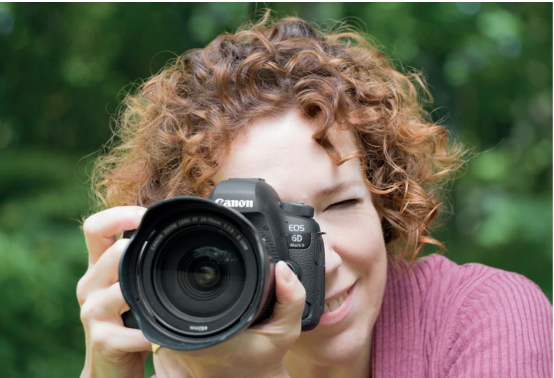
▲ *Das Gehäuse aus Aluminium und glasfaserverstärktem Polykarbonat liegt gut in der Hand und ist gegen Staub und Spritzwasser geschützt. Das gab uns die nötige Sicherheit, auch unter widrigen Bedingungen bei Nebel und Nieselregen mit der EOS 6D Mark II auf Motivjagd zu gehen.*
