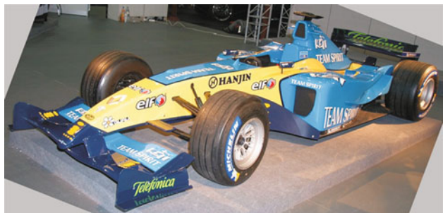
Abb. A.6 Formel-1-Wagen: Monoposto mit freistehenden Rädern und offenem Cockpit
