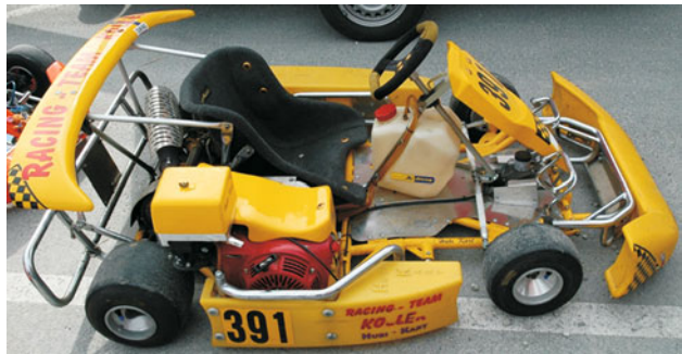
Abb. A.8 Kart: Monoposto, keine beweglichen Teile bei der Radaufhängung, kein Differenzial, asymmetrischer Aufbau
