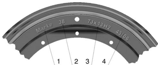
**Abb. A.5** Kennzeichnung von Rädern nach DIN 7829, 1 Felgenreiße (Breite  $\times$  Durchmesser), 2 Hump- und Felgenbettausführung, 3 Einpresstiefe 45 mm, 4 Hersteller, Teile-Nummer und Herstelldatum (Wochen-/Jahresstempel)
