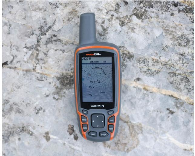
*Garmin-Navigationshandgeräte wie das GPSMAP 64s sind mit einem 2,6-Zoll-Display ausgestattet, das selbst bei Sonneneinstrahlung gut ablesbar ist. Die Antenne sorgt für einen ausgezeichneten Empfang. Das Gerät umfasst einen barometrischen Höhenmesser und einen 3-Achsen-Kompass.*
