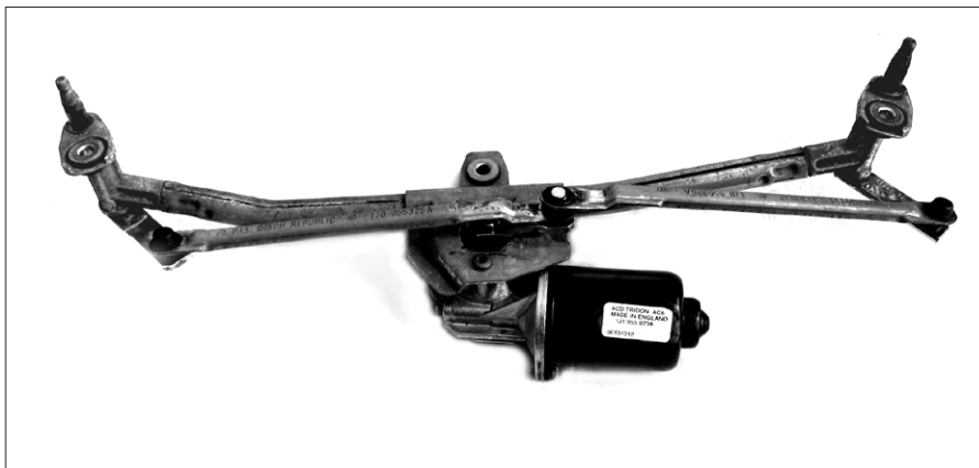
Abbildung 2.4: Mechanisches Wischergetriebe (Quelle: Hans Haase, Wikimedia Commons, CC BY-SA 4.0).
