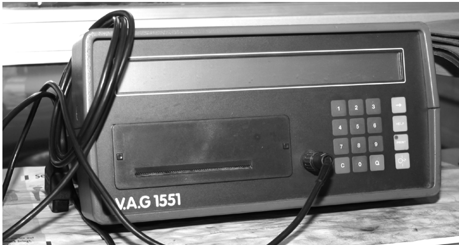
Abbildung 2.6: Professionelles älteres Werkstatt-Diagnosegerät mit Textdisplay und Belegdrucker.
