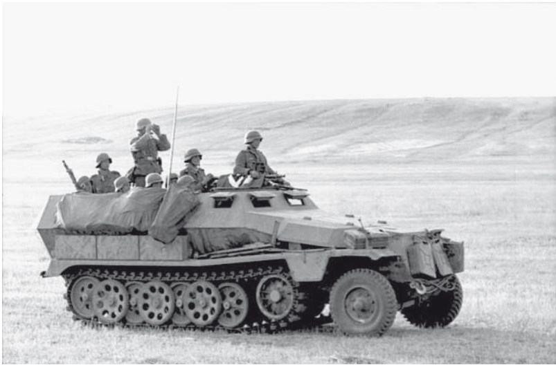
Abb.: Die Adlerwerke bauten die Fahrgestelle für diesen mittleren Schützenpanzerwagen (Sd. Kfz 251), hier Ausführung C in Russland, August/September 1942.
