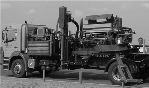
**Bild 1.2** Prototyp eines Fahrzeugs zum automatischen Rammen von Pfosten für Schutzplankensysteme (Förster Montage GmbH)
