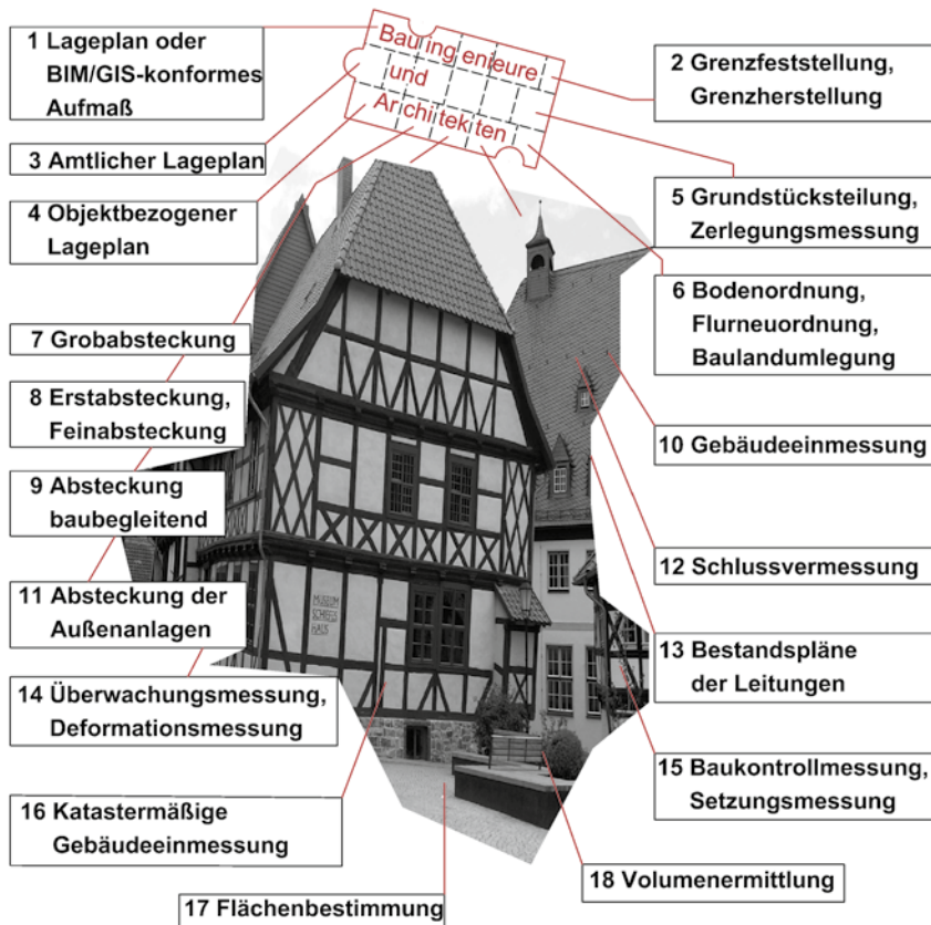
Bild 2.1 Vermessungsaufgaben für bauliche Anlagen
