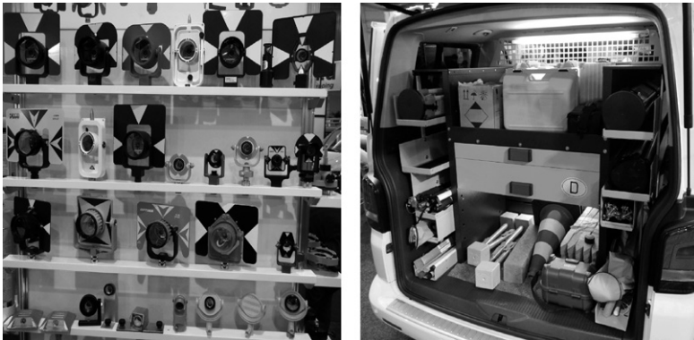
Bild 2.4 Reflektorprismen-Vielfalt und Blick auf die Messbusausstattung
