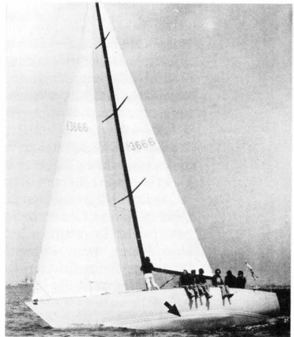
Abb. 5 Lebender Ballast in Aktion. Vorausgesetzt, der Oberkörper befindet sich noch innenbords, gilt das Überbordhängen der Beine als legitimes Mittel, um unbewertet die Stabilität zu vergrößern. Es gibt gute Argumente dafür, daß diese Mode, die Mannschaft auf dem Schandek aufzureihen wie eine Schar Spatzen auf einer Telefonleitung, schlechte Seemannschaft ist.
