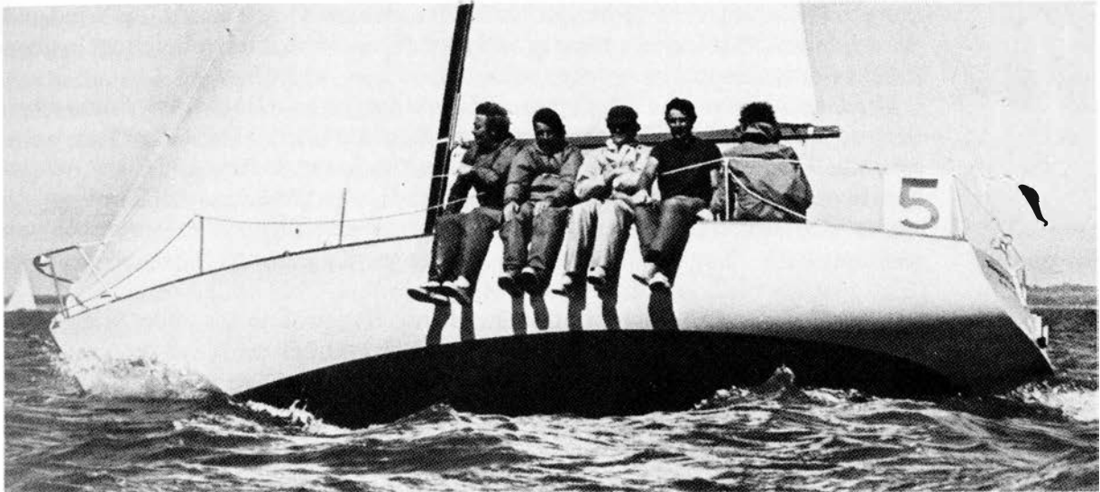
Abb. 5 Lebender Ballast in Aktion. Vorausgesetzt, der Oberkörper befindet sich noch innenbords, gilt das Überbordhängen der Beine als legitimes Mittel, um unbewertet die Stabilität zu vergrößern. Es gibt gute Argumente dafür, daß diese Mode, die Mannschaft auf dem Schandek aufzureihen wie eine Schar Spatzen auf einer Telefonleitung, schlechte Seemannschaft ist.
